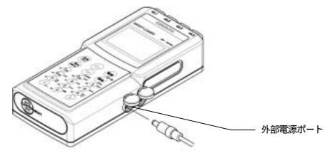
「 D C I N 」の刻印があるポートの蓋をあける。( 上図参照 ) A C アダプタのプラグをポート内に挿入して、突き当たるまで差し込む。 A C 1 0 0 V のコンセントに A C アダプタを差し込む。
