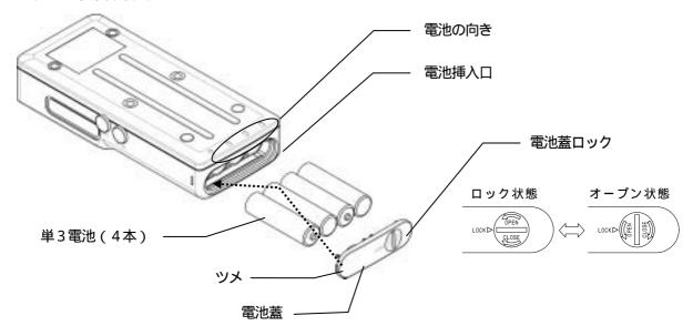
コインなどを用いて電池蓋のロックを反時計回りに回転させオープン状態にする。 電池蓋を取り外し、電池挿入口を開く。
