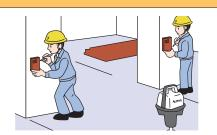
目に見えないレーザー光を水平に360°飛ばし、受光器でそのレーザーを キャッチすることで水平な高さを測ります。
